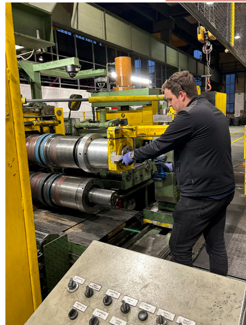
Messerwelle nach dem Umbau
